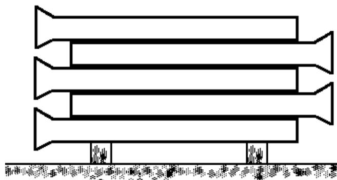
Con l'uno o l'altro sistema verranno limitate le altezze delle pile e, quindi, il numero degli strati in funzione inversa del diametro dei tubi, allo scopo di non sovraccaricare i tubi degli strati inferiori.
